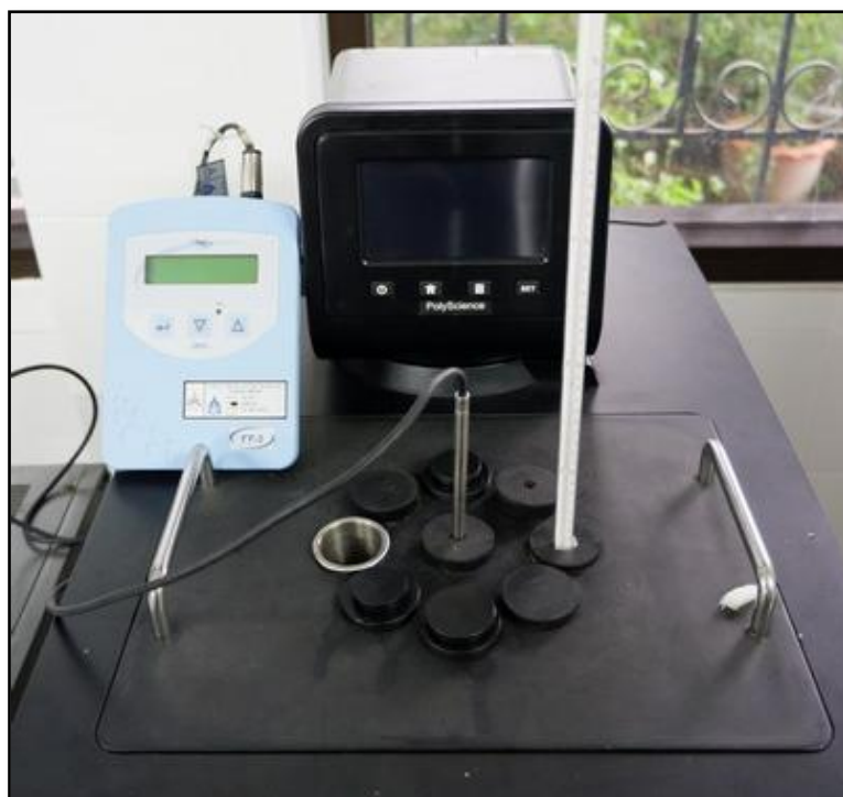
รูปที่1: การติดตั้งเทอร์โมมิเตอร์ลงในแหล่งกำเนิดอุณหภูมิแบบใช้ของเหลวเป็นตัวกลาง (Liquid Bath)
